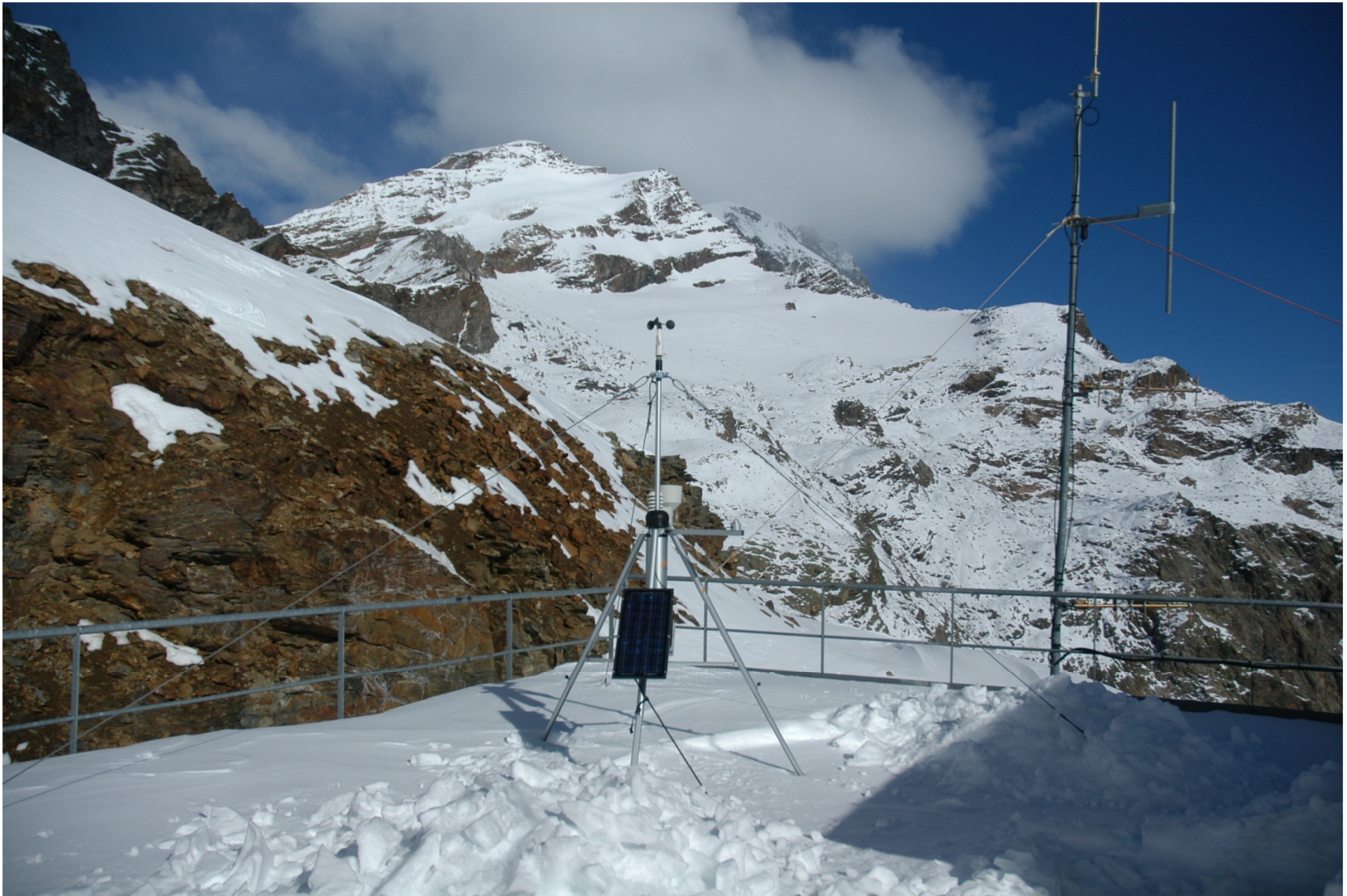
Stazione meteorologica portatile MAWS per lo studio dell'andamento meteorologico nella stagione vegetativa - Arpa Piemonte – dip. Sistemi Previsionali
